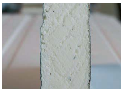
Snitt genom väggisoleringen av PUR-paneler (byggmaterialklass B)
