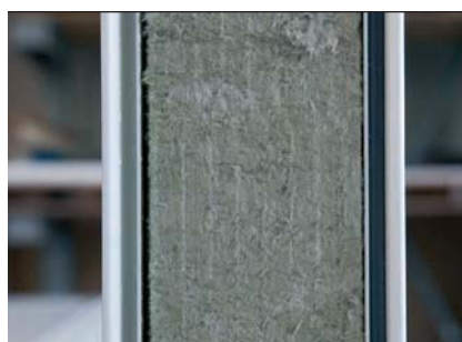
Väggisolering av mineralull (byggmaterialklass A) Fogkant till nästa panel
